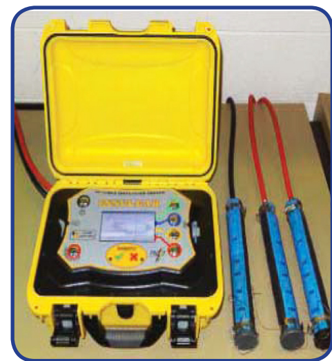
Thiết bị thử nghiệm cách điện cáp cùng với các đầu nối cáp vạn năng
